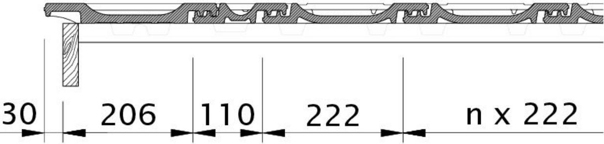
Zeichnung OPTIMA Ortgang links mit Ortgangblech und Doppelwulst ODL
