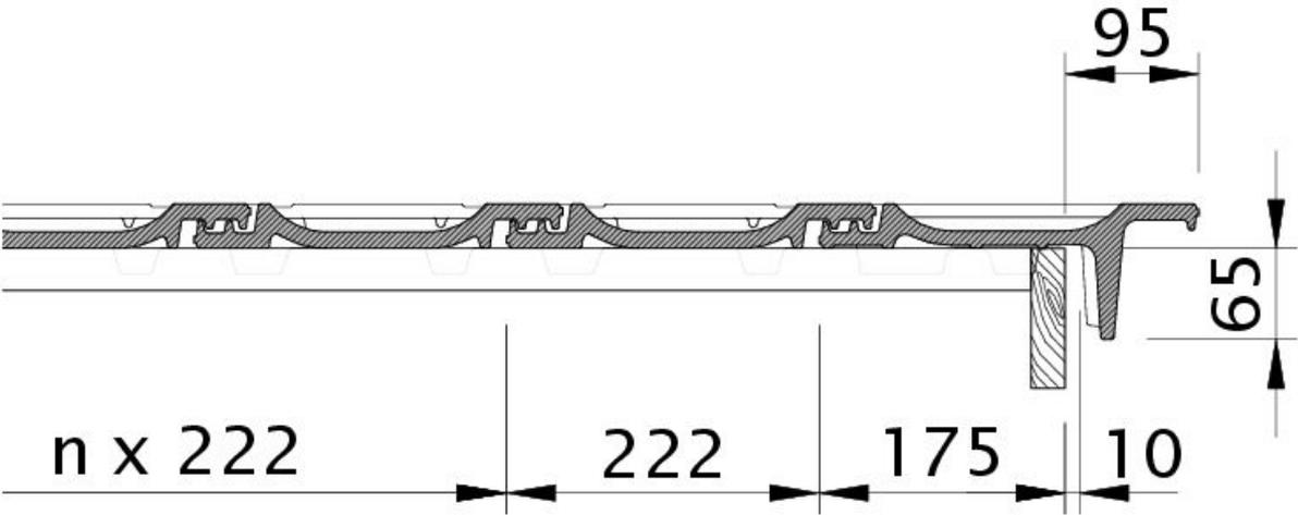
Zeichnung OPTIMA Ortgangziegel rechts mit Ortgangbrett OBR
